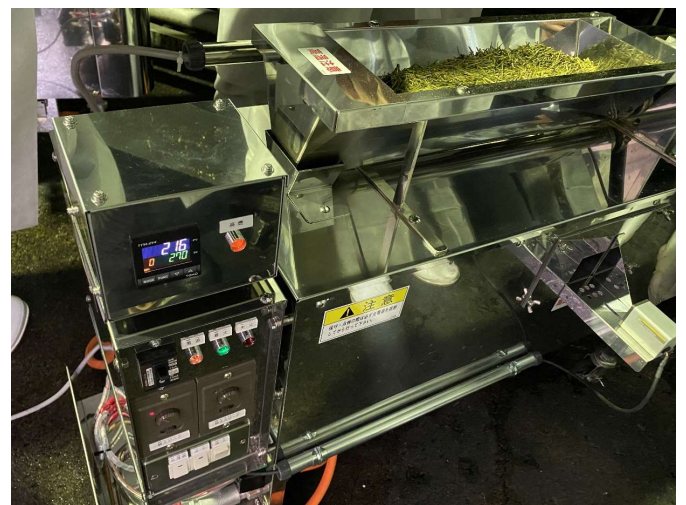
既成品を改造し、製造ラインに 実装した葉燻し装置
